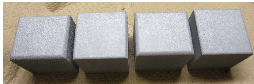
CFCブロック(W溶射後)
