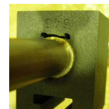
既知欠陥加工試験体
