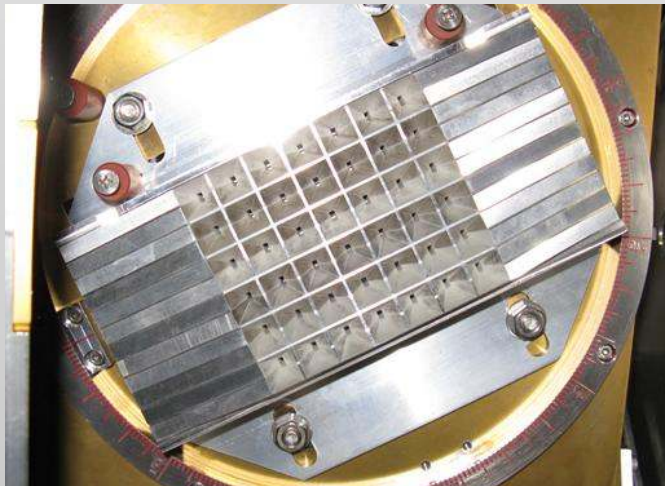
Fig.10 6x7ch 2次元アンテナアレイ (HMA 6層スタック)
