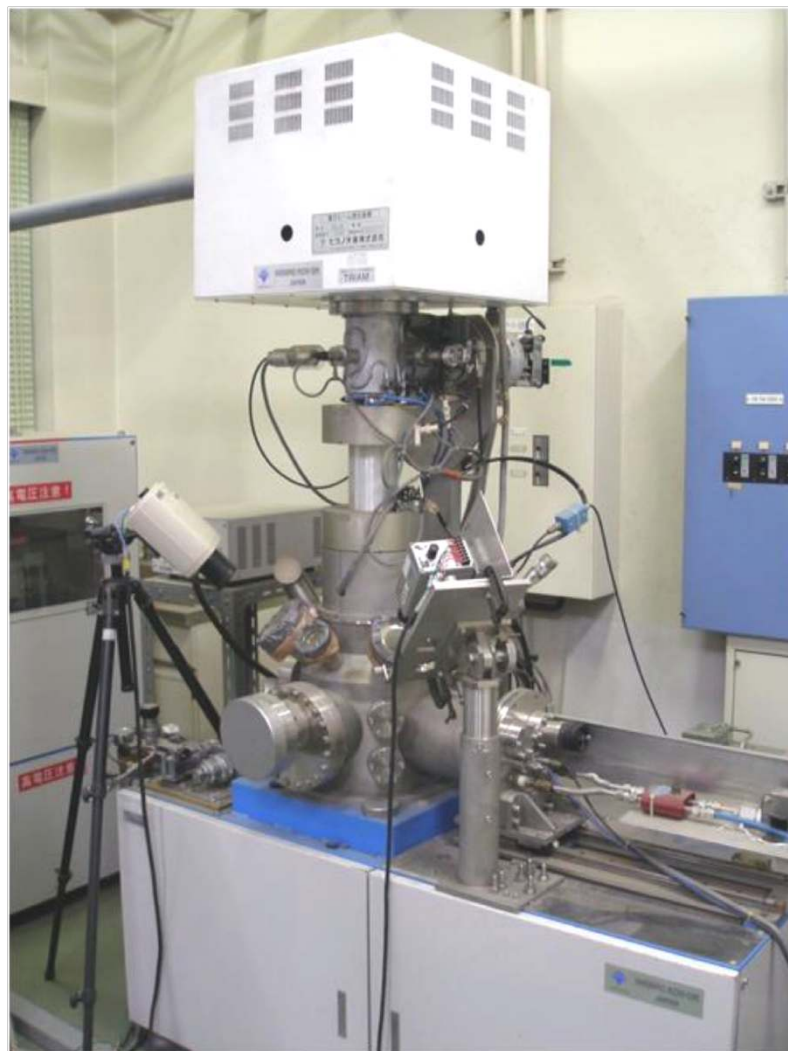
電子ビーム熱負荷実験装置(EBTH) (九州大学・応用力学研究所)
