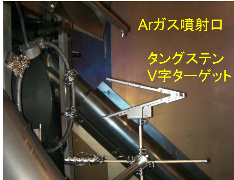
端部ミラー出口に設置したV字ターゲット
