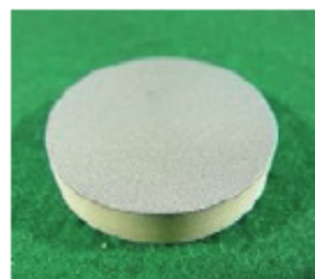
基材： アルミナ \phi 25 \times 5t
