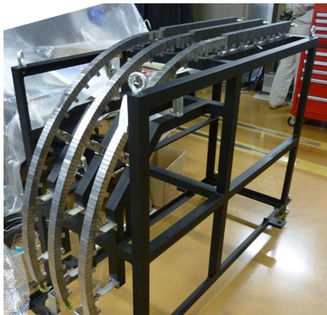
赤外サーモグラフィ検査用フレームに組み込まれたPFU#1 (3体のPFUを同時に検査可能 : 2011年6月)
