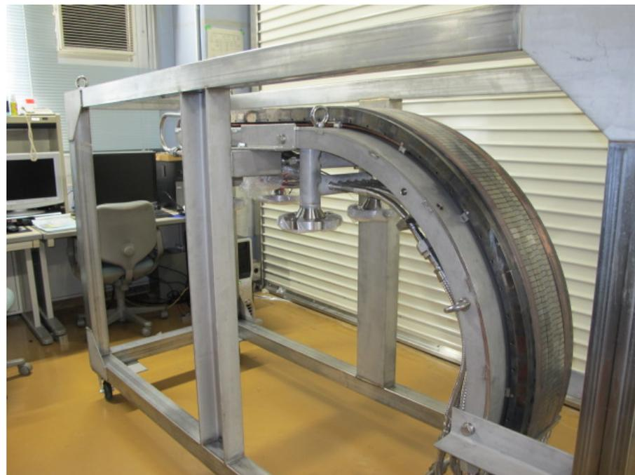
高熱負荷試験用のテストフレームに装荷されたPFU#1 (6体のPFUを同時に試験可能 : 2012年5月)
