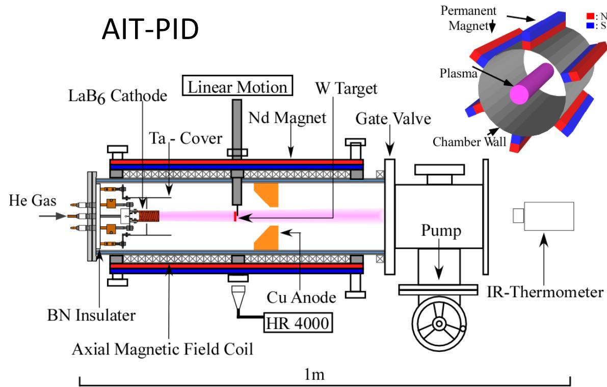
Plasma Density  $> 1 \times 10^{18} \text{ m}^{-3}$ ; Ion Flux :  $1 \times 10^{22} \text{ m}^{-2}\text{s}^{-1}$
