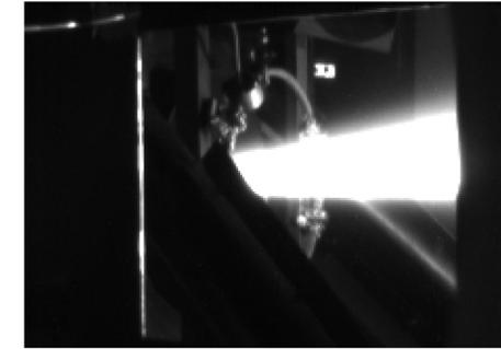
プローブ挿入時の流出プラズマによる発光
